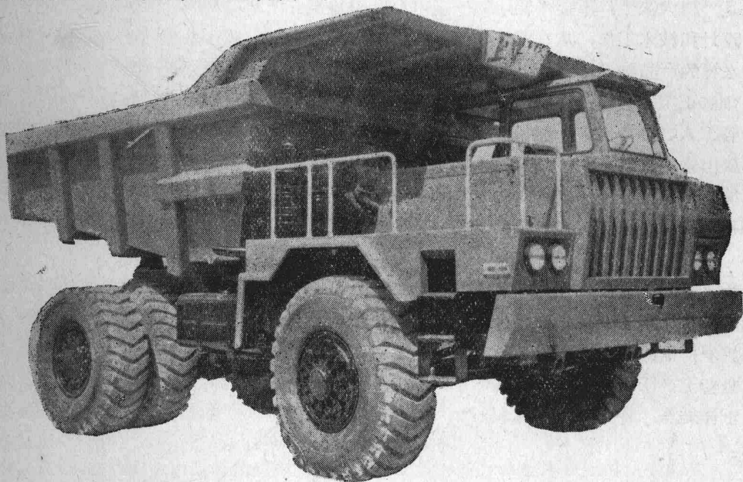
图 1 上海牌 32 吨自卸汽車外形
