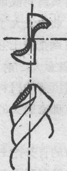
圖 7 磨寬鑽尖凹槽。
