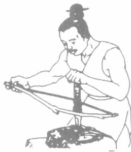
图 1-4 半坡人用弓钻钻孔
