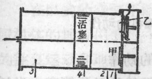
圖 4 單級往复式空气压缩机的动作
