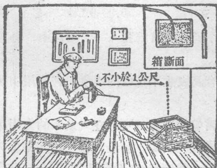
图 8. 在室内检查电雷管的导电性
