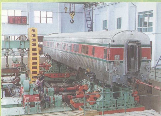
西南交通大学国家级牵引动力实验室正在对车辆性能进行实验鉴定
