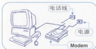
Modem分为内置的**Modem**卡和外置**Modem**。内置的插卡式**Modem**要占用计算机的扩展槽，价格较为便宜，但安装也较为复杂；外置**Modem**为台式，安装简易，性能较好。
