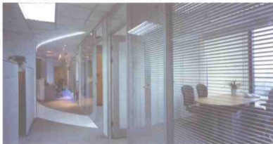
双层玻璃内藏百叶隔断墙
