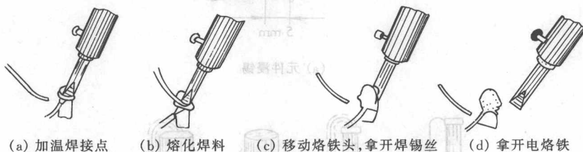
图 1-3 焊接步骤
