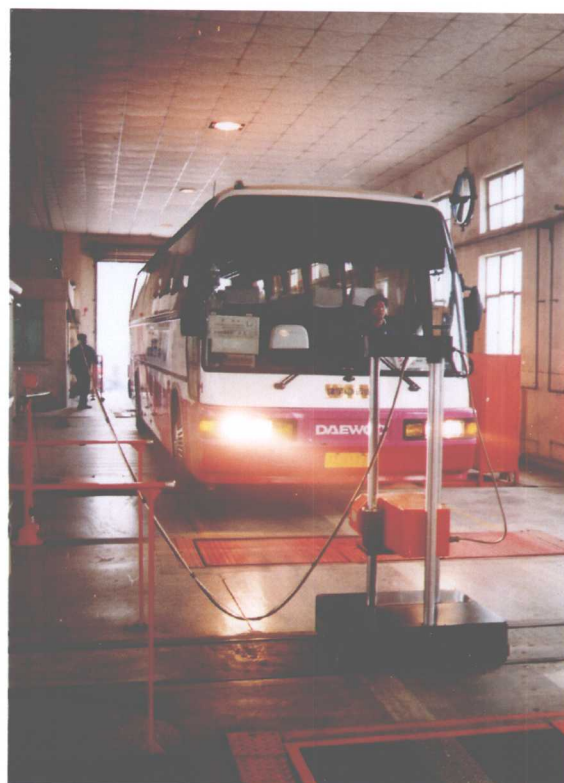
特种车修理厂的汽车安全技术性能检测线
