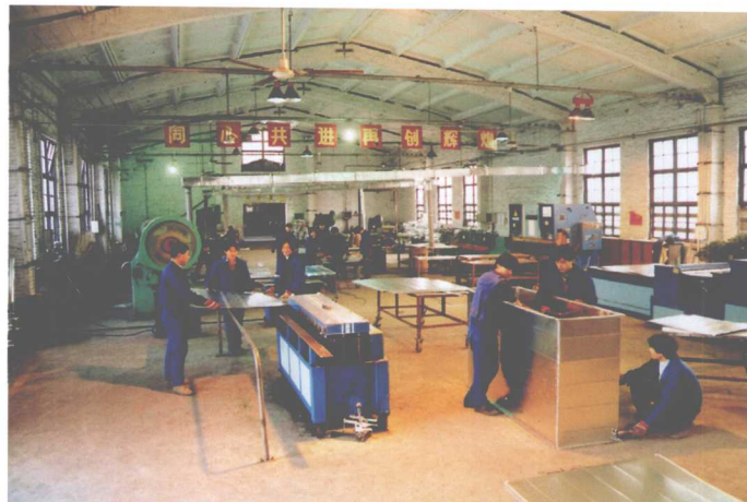
奥凯设备安装工程有限公司的职工们正在紧张地制作中央空调通道
