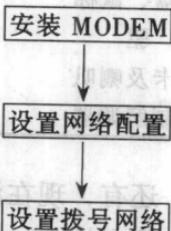
第二步设置“网络配置”。由调制解调器连接上网，一定要设置网络配置，它包括两个部分的内容：其一是在控制面板/网络中安装“拨号网络适配器”（注意，是拨号网络适配器不是“网络卡”），并安装“TCP/IP”通讯协议。第二部分是设置拨号上网的“拨号网络”。由于 Internet 互联网上使用的通讯协议是“TCP/IP”，在设置中，取消其他的通讯协议如
