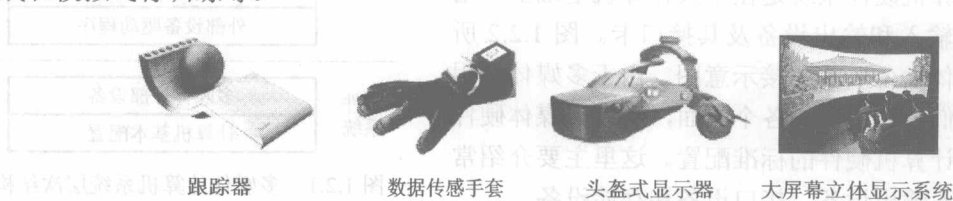
图 1.1.1 虚拟现实技术采用的一些特殊的输入/输出设备
