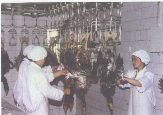
彩图 15 在传送链上 人工拔除大毛
