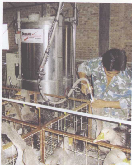
彩图 12 法国最新液压式填饲机的填饲操作
