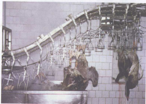
彩图 14 屠宰放血后的鹅 随传送链进入浸烫池
