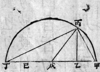
法以中率四命爲四尺爲股。首率二尺與末率八尺相減餘六尺。折半得三尺爲勾。首率二尺與末率八尺相加得十尺。折半得五尺爲弦也。如圖甲乙爲首率二尺。丙乙爲中率四尺。乙丁爲末率八尺。今以甲乙與乙丁相和。共爲甲丁十尺。而以丙乙立於甲丁線相和之乙
