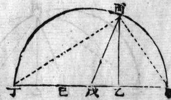
法以四尺爲首率。六尺爲中率。將中率六尺自乘得三十六尺。用首率四尺除之。得九尺爲末率。乃以中率六尺爲股。首率四尺與末率九尺相減餘五尺。折半得二尺五寸爲勾。首率四尺與末率九尺相加得十三尺。折半得六尺五寸爲弦也。如圖甲乙爲首率四尺。丙乙爲中率六尺。今以中率六尺自乘。用首率四尺除之。乃得乙丁末率九尺。爰以甲
