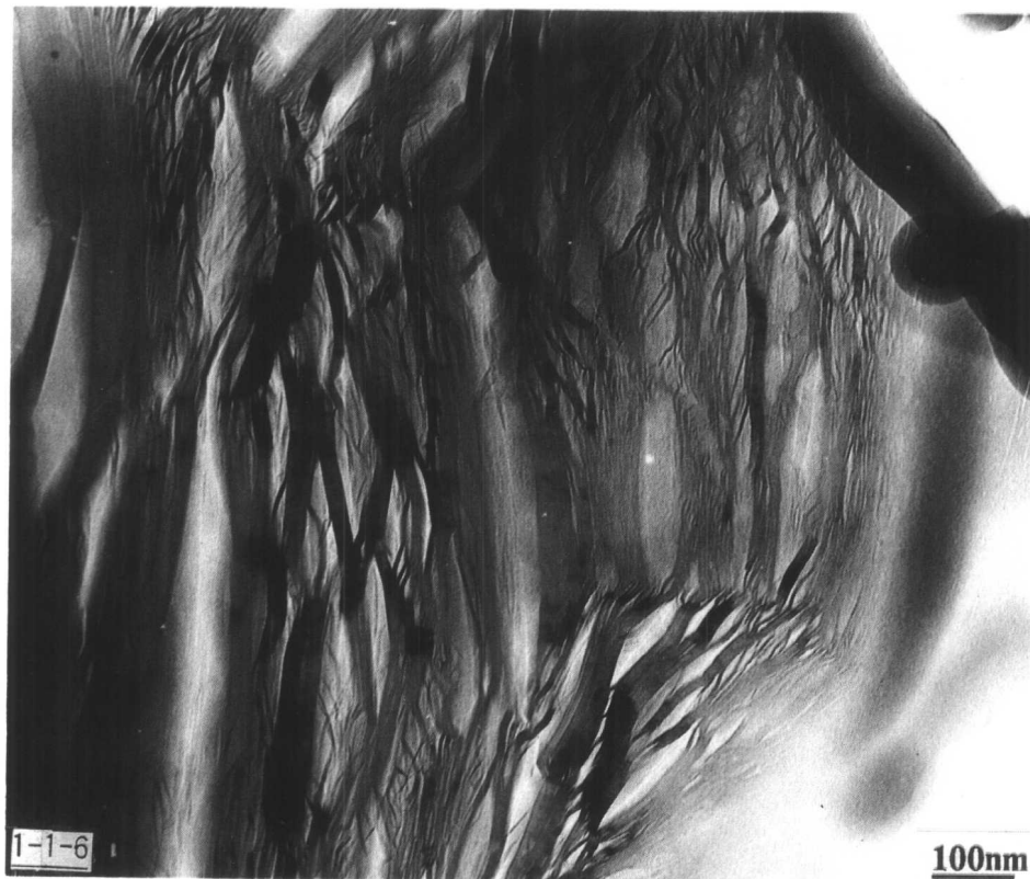
圖1-1-6 用雙面離子減薄法製備的瀝青碳TEM明場象，瀝青碳受到輕度蝕刻
