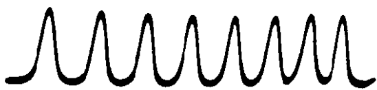
图 4 在钴铋硝酸盐中,二价钴离子 ( s = \frac{1}{2} , I = \frac{7}{2} ) 的超精细结构图,不等的间隔是由于二级移位效应引起的,这种效应在中等场时是相当大的。(参看 R. S. Trenam)
