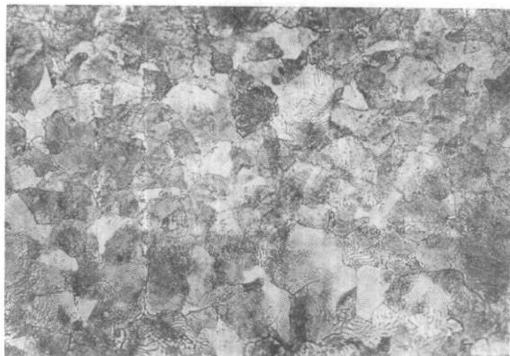
图1-11 20钢渗碳层过共析组织 500× 珠光体和沿原奥氏体晶界分布的少量网状碳化物。
