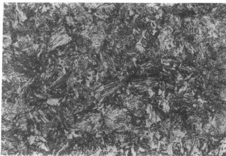
图1-6 20钢低温回火组织 500× 910°C加热30分，盐水冷却；300°C回火，空冷。 回火马氏体。
