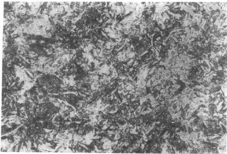
图1-17 20钢渗碳淬火、低温回火的心部组织 500× 回火马氏体和少量铁素体(白色小块)。
