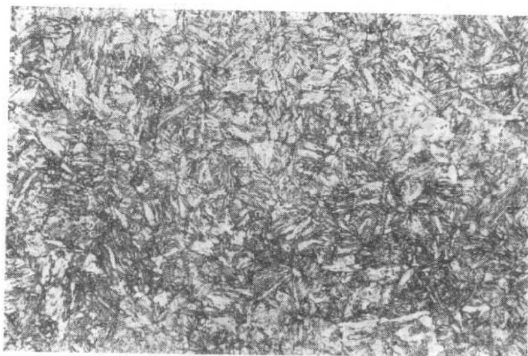
图1-8 20钢高温回火组织 500× 910°C加热30分，盐水冷却；500°C回火，空冷。 回火索氏体。
