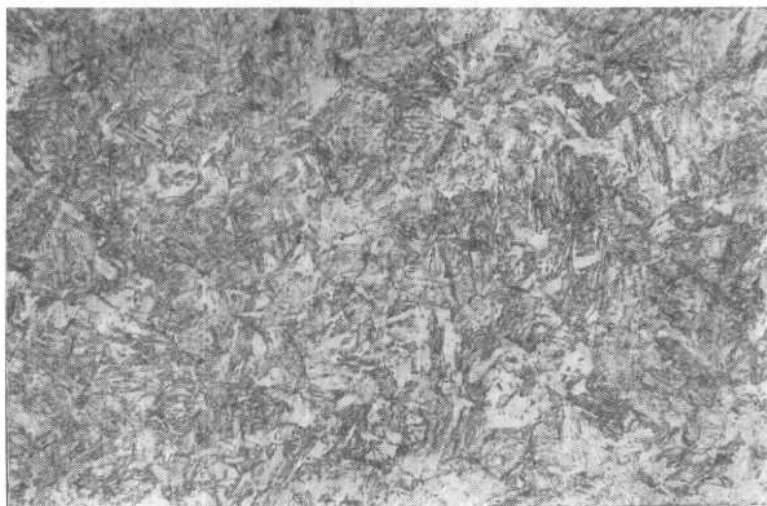
图1-4 20钢淬火组织 500× 910°C加热30分，盐水冷却。 马氏体。
