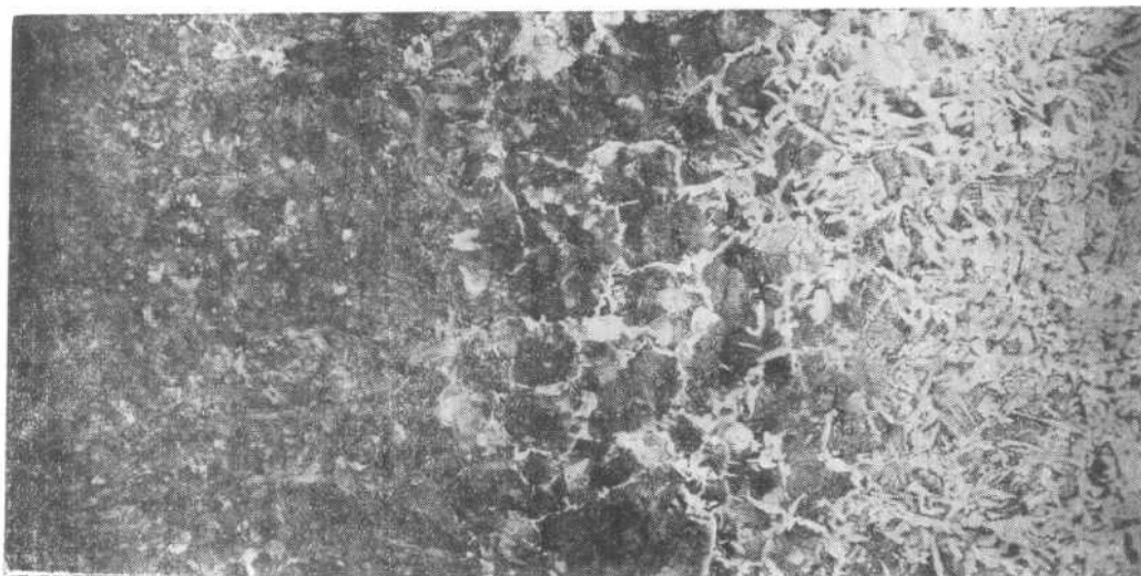
图1-10 20钢渗碳后空冷组织 80× 920℃渗碳 6.5小时, 空冷。
