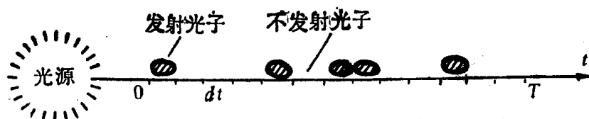
图 1.3—4 发射光子的贝努利时间序列, 在时间间隔 dt 独立发射一个光子或不发射光子
