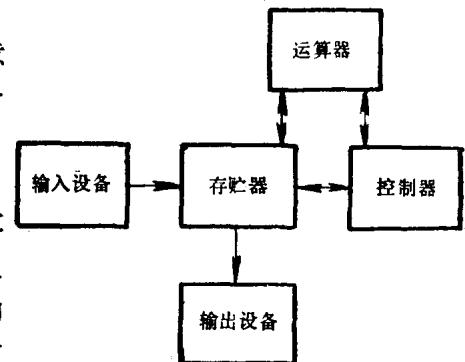
图 1-1 电子数字计算机简框图
