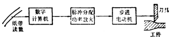
图 1—8 步进电动机开环控制
