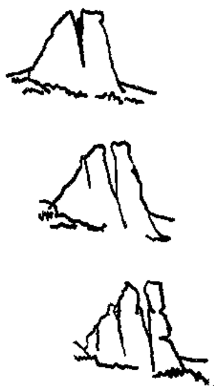
图1-8 冰劈作用使岩石裂隙扩大
