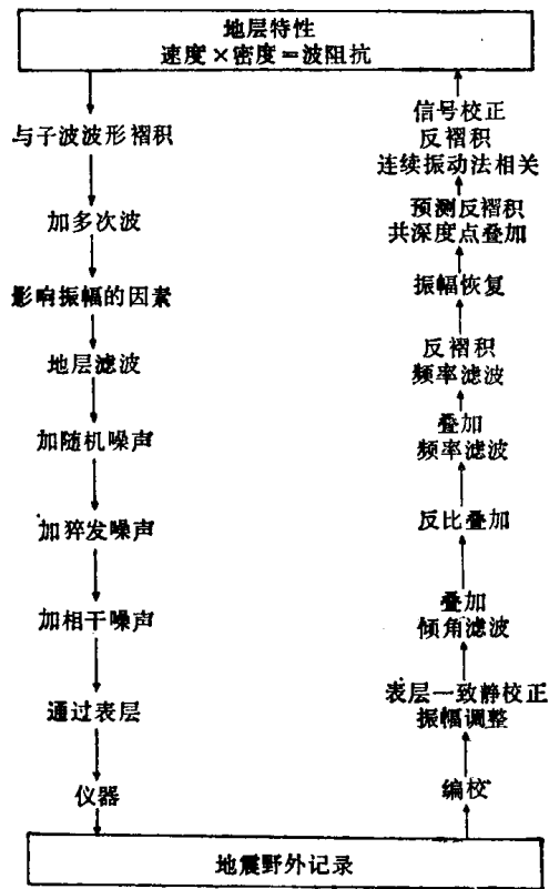
图1 左边一行为地震噪声源,削弱其作用的处理程序示于右边一行。进行处理的次序通常并不是图示的这样
