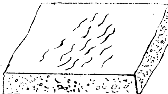
图 2-6 养生不好产生的塑性收缩裂缝
