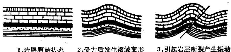
图 1.2 构造变动与地震形成示意图
