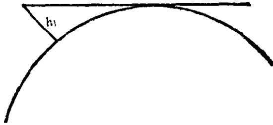
图 1-4 被干扰电台天线高度极低
