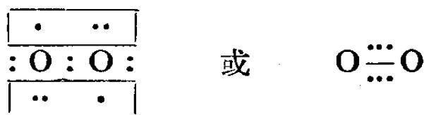
即氧分子的键相当于三键，其中包括一个单键和两个三电子键。氧分子中两个氧原子结合得很牢固，所以氧分子分解为原子所需的能量相当高：每摩尔单质氧为 117.3 千卡。
