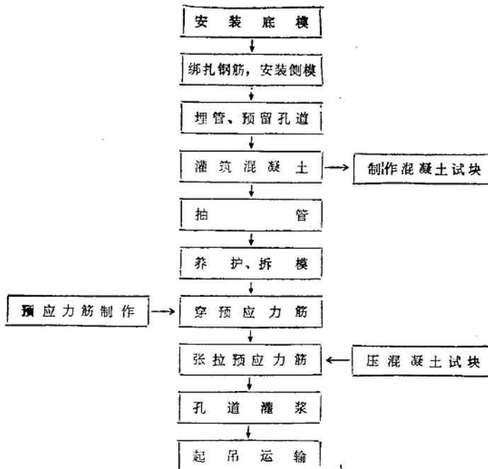
预应力筋一般由单根粗钢筋、钢筋束、钢绞线束或钢丝束所制成。张拉设备主要由油压千斤顶和高压油泵组成，灌浆则使用电动或手动灰浆泵进行。
