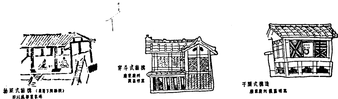
图 1-21 东汉明器中所表示的房屋结构型式
