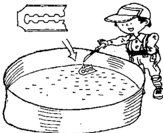
**动手做** 找一把废旧刮须刀片,用手将它扳成船形(如上图)。把这只“小船”放在干净的洗脸盆水面上,在中孔靠船头处滴一滴肥皂水,船就会快速地从洗脸盆这一头驶向那一端了。
