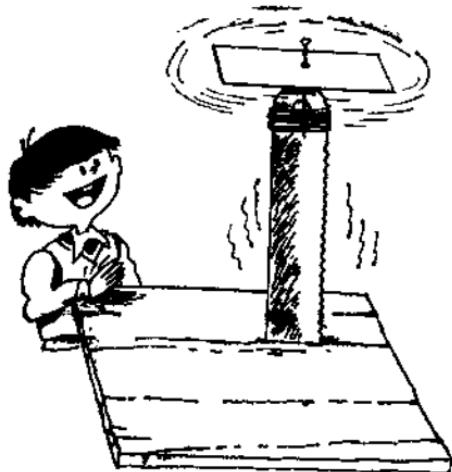
奇怪的是：只要用手拍一下锯条，使锯条振动，螺旋桨便会旋转起来，旋转速度和锯条振动的频率（每秒钟来回运动的次数）一致。如果使锯条不停地振动，螺旋桨就会不停地旋转下去。
