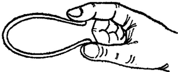
**动手做** 捏住一段铝丝的两端，把它们弯到一起，松开手，铝丝两端会弹开约 0.5 厘米；再并拢，一松手，它还是会弹开……瞧，铝丝果然有弹性。采取类似的方法用焊锡丝、保险丝等通常认为毫无弹性的材料做试验，你一定也会体会到它们都有弹性。
