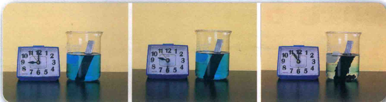
■ 图 16.6 锌和硫酸铜溶液反应, 会有金属铜沉积在锌片上。
