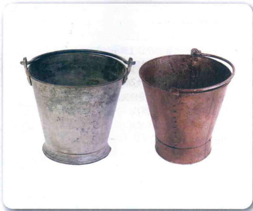
■ 图 16.2 图中的水桶都是钢铁做的,左边的水桶表面镀了锌。在钢铁表面镀上一层更活泼的金属(如锌),可以防止铁被氧化。锌比铁更容易失去电子,先于铁被氧化,并会形成一层坚硬的氧化锌保护层。锌与氧化锌阻止了钢铁与氧气直接接触,从而防止了钢铁生锈。
