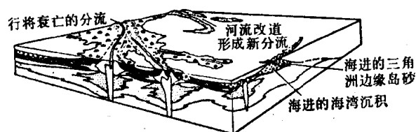
图 22 指状沙坝沉积的几何形态和沉积特征。注意砂体向下倾方向增厚和分叉。“干净”砂带代表分流河口沙坝顶环境，侧翼的泥质砂代表末梢沙坝环境。据菲斯克 (1961)
