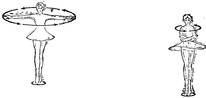
图 1-5 角动量守恒图解。当滑冰者拉回手臂时旋转速率更快。同样地，当缓慢旋转的星云收缩时，其旋转速度加快
