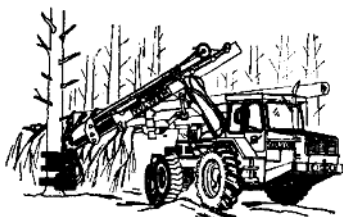
图6 VOLVOBM920型伐木—打枝—造材联合机
