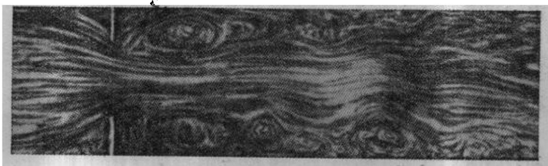
图3 管道里装有节流件的流束
