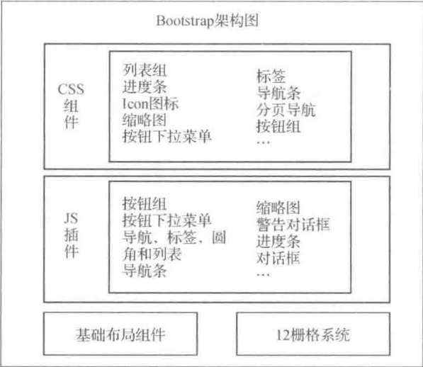
图 3 档案信息资源共享平台前端框架 Bootstrap 架构图
