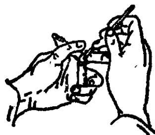
图 1-9 用倾泻法将沉淀和溶液分离
