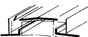
垂直挡风板带斜挡风板
