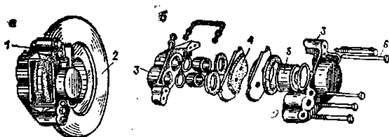
图 1-5 盘式制动闸 (a) 及其支架的构造 (b)
