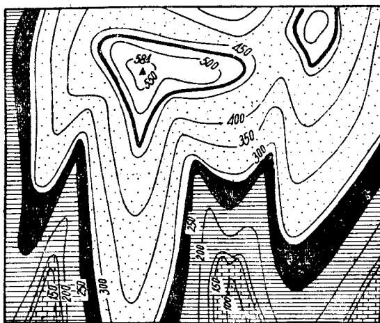
图 2—7 水平岩层的出露分布特征 上图—立体图 下图—平面图（地形地质图）
