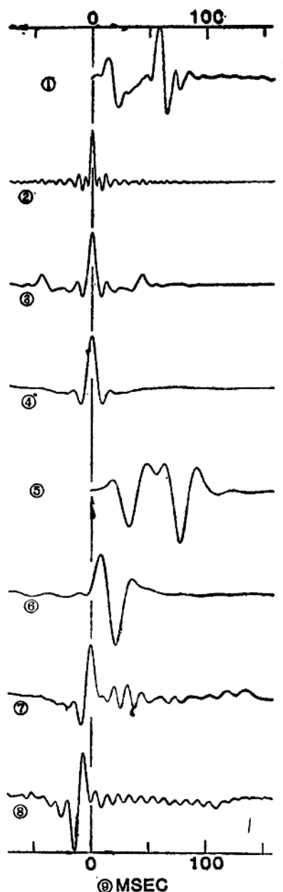
图1-3 零相位处理流程
