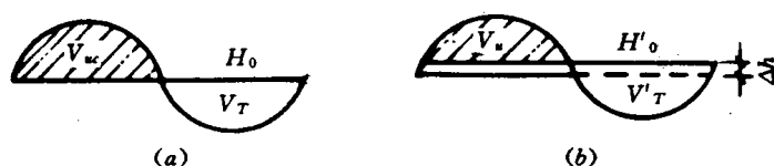
图 1.7 设计标高调整计算示意 (a)理论设计标高;(b)调整设计标高
