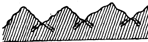
图2 金属中腐蚀的蔓延
