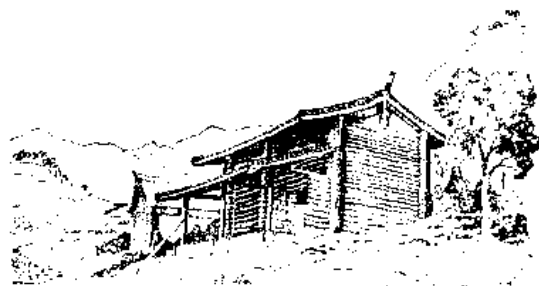
图3 井干式结构示意图
