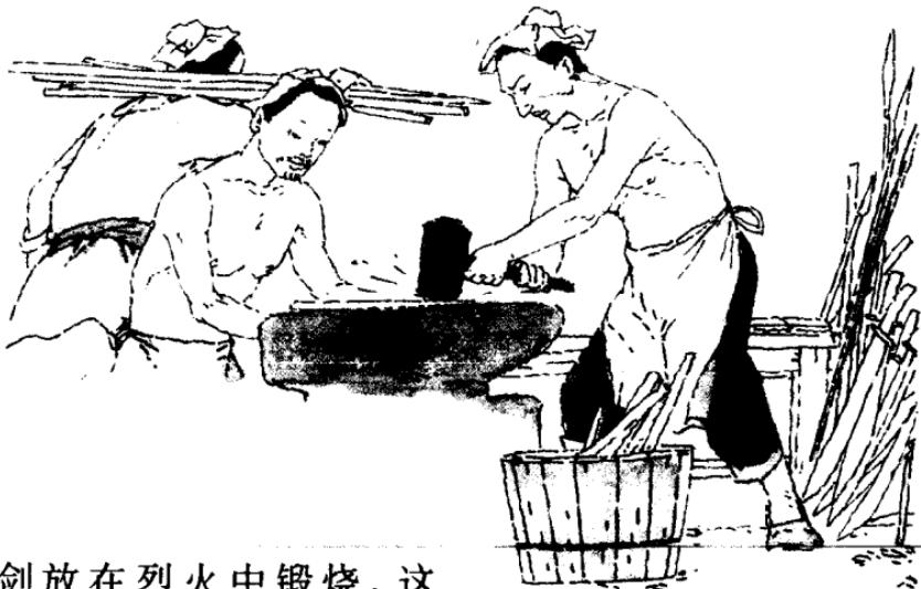
剑放在烈火中煅烧，这样，制成的宝剑就更不易生锈。据现代科学技术测定，这层特殊涂料含有铬，而铬是一种不易生锈的金属。这种给金属表面穿一件外衣的处理方法，与现代的金属镀铬工艺十分接近。宝剑有了这层“外衣”保护，当然不会生锈了。
