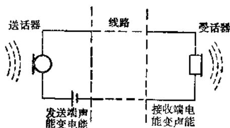
图1—2 最简单的单向通话电路
