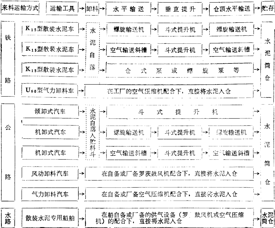
散装水泥卸、贮工艺及设备 表4-1-4
