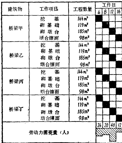
图 1-2 平行作业法施工进度图
