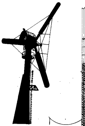
图1-2-1 盖瑟风力发电机(200 千瓦,直径24米)
