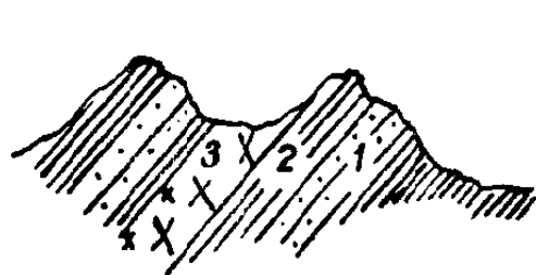
图 4 岩床剖面示意图 1—砂岩；2—页岩； 3—辉绿岩。
