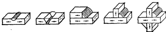
图1-5 各种接头型式的热传导示意图
